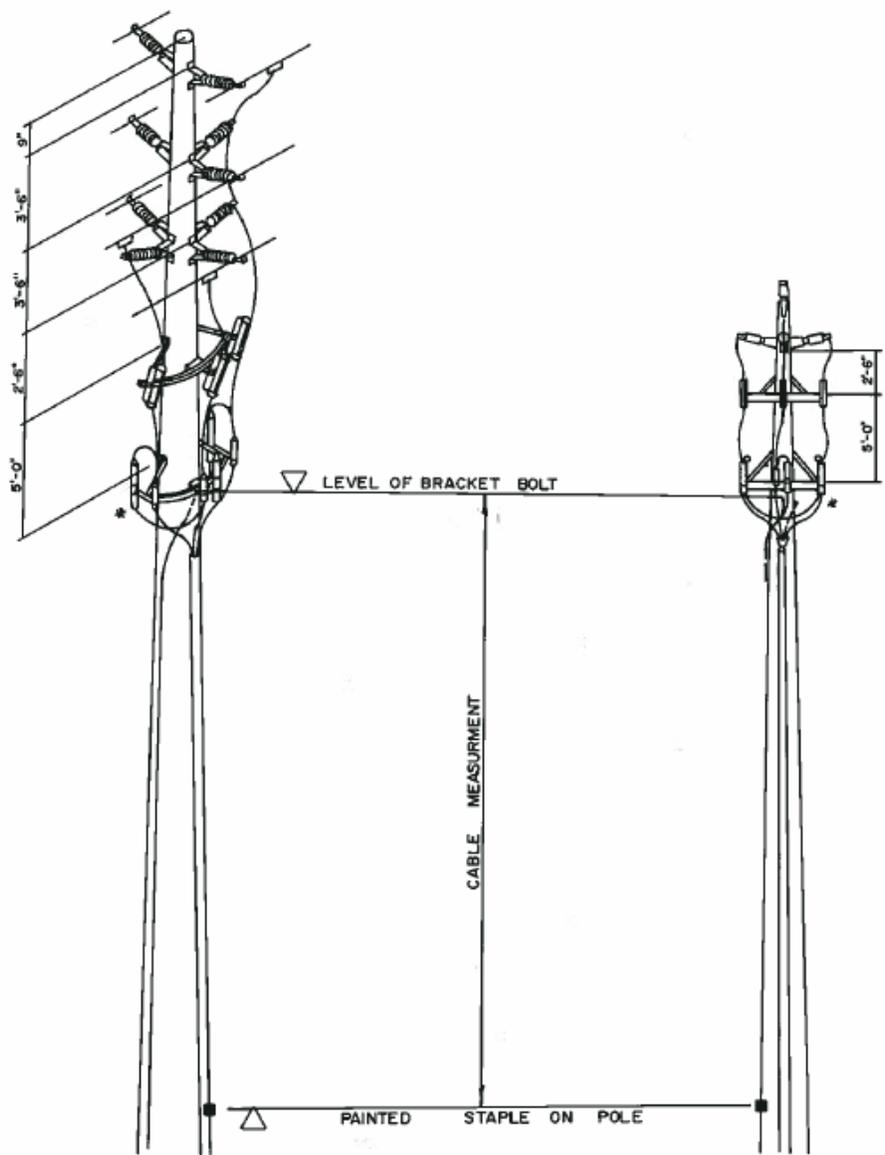
\* CONTRACTOR TO MAKE ALLOWANCE FOR OUTER CABLES, RADIUS-AND-TERMINATOR LENGTH AND SUPPORT.
